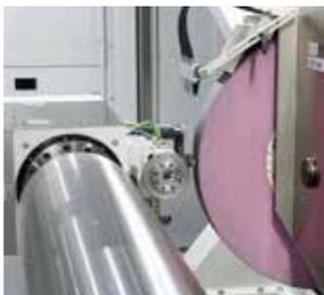
Anwendungen: Schleifen z. B. von Hartmetallschichten,
